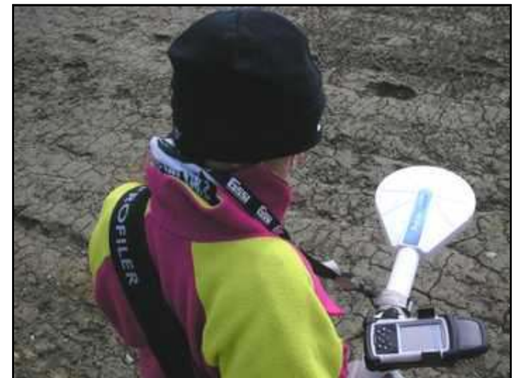
Acquisizione dipolo verticale (dettaglio bobina ricevente)
