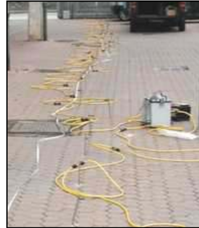
Rilievo su pavimentazione sopra rifiuti interrati
