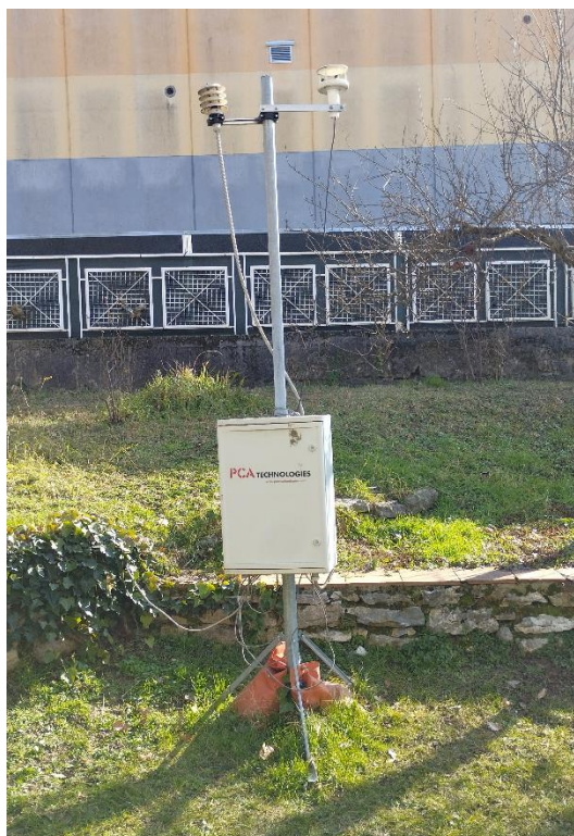
Fig. 1. Postazione di misura del naso elettronico in via Pederzini a Rovereto.
