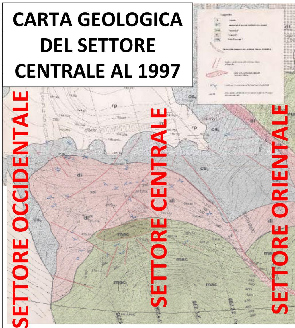
In base al rilievo di superficie esistente, i fronti rocciosi sembravano avere un assetto geostrutturale relativamente semplice. Essi interessano le formazioni stratificate della “Scaglia”, della “Ma-iolica”, dei “Diaspri” e del “Selcifero”.
