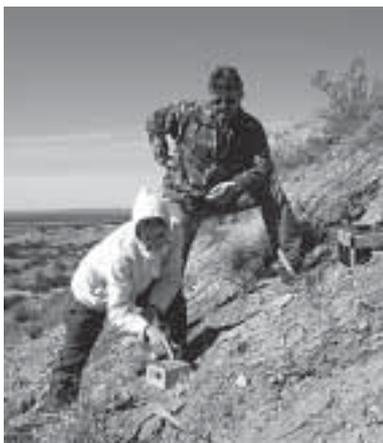
grafia elettrica che nuove tecnologie di sismica passiva che rilevano le frequenze di risonanza degli strati sedimentari. Sono state eseguite 93 curve HVSR (Horizontal to Vertical spectral ratio) e si sono pure effettuate, utilizzando macchine fotografiche digitali agganciate a speciali aquiloni, fotografie da bassa quota degli affioramenti geologici ponendo le basi per nuove ricerche volte alla completa ricostruzione ambientale del territorio.
