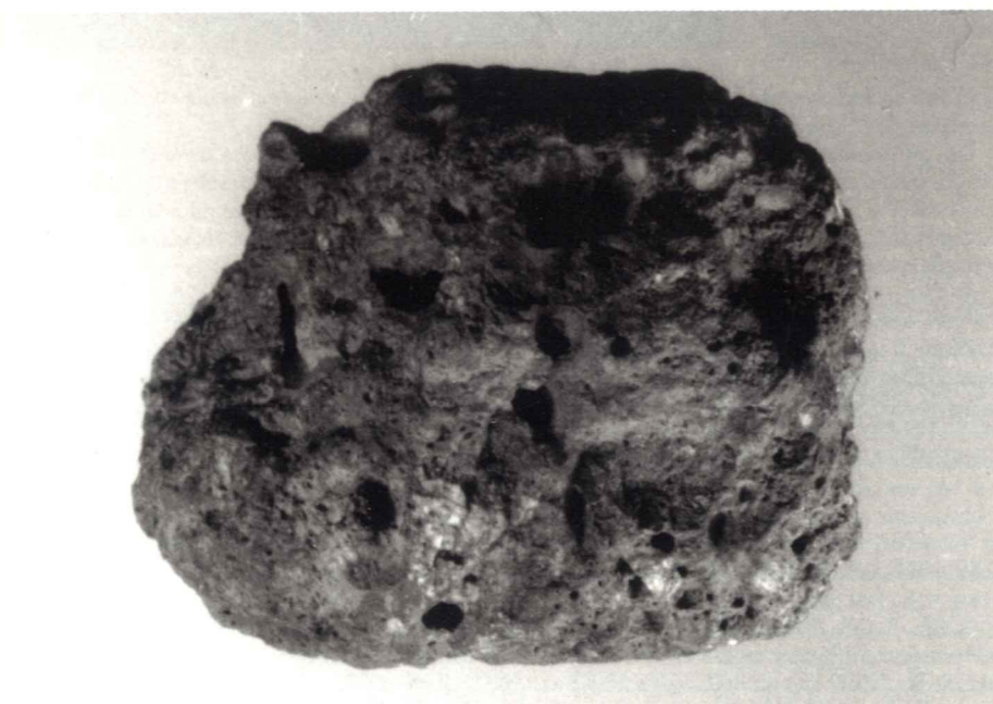
Fig. 3 - Levico - Località «Quaere». Scoria di fusione sottoposta ad indagine metalloscopica: vista posteriore.
